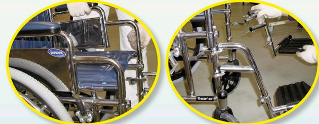
扶手和腳踏可否拆除及鎖緊，零件有否鬆脫或損壞
