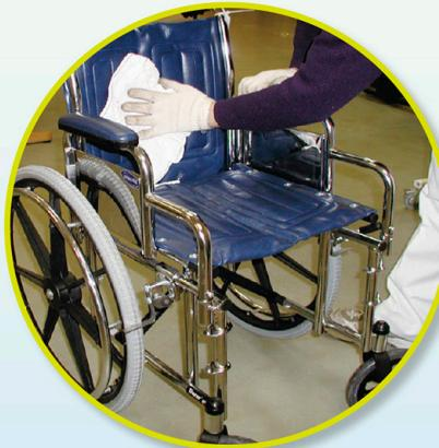
定期用潤滑機油為輪椅唧油，包括車輪軸及其他轉動部份的零件
