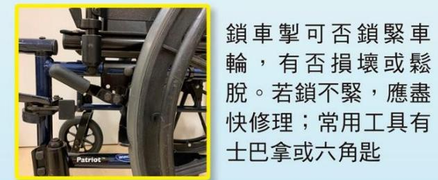
鎖車掣可否鎖緊車輪，有否損壞或鬆脫。若鎖不緊，應盡快修理；常用工具為士巴拿或六角匙
